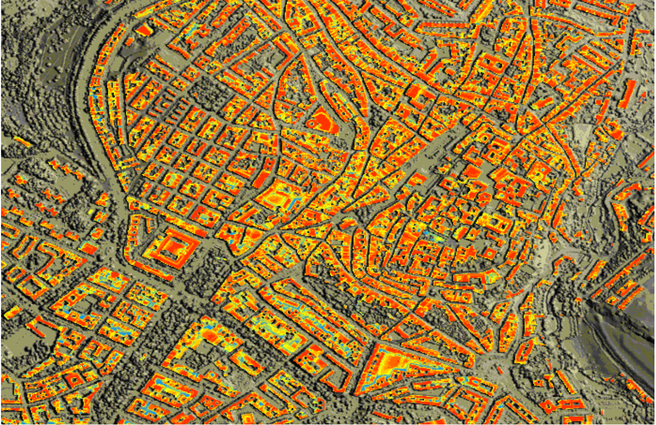
Figura 6: Potencial solar fotovoltaico de las cubiertas sobre datos LIDAR.
